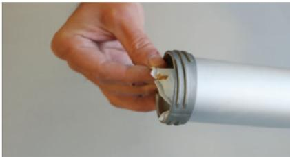
**7** Achten Sie darauf, dass sich der Skamol Glue-Beutel vollständig in der Skamol Glue Pistol befindet.
