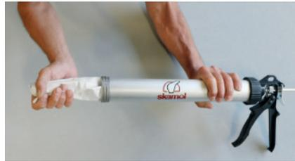
**5** Setzen Sie den Skamol Glue-Beutel in die Skamol Glue Pistol ein. Das kleine Loch muss in Richtung der Öffnung zeigen.
