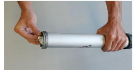
**6** Drehen Sie am Skamol Glue-Beutel, sodass er sich leicht in die Skamol Glue Pistol einsetzen lässt.
